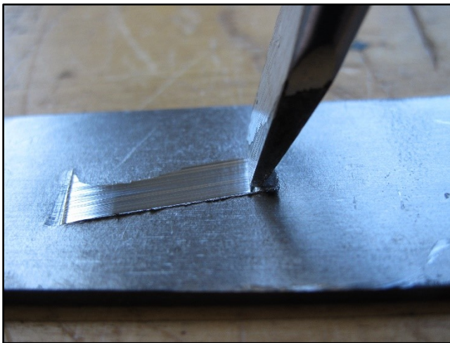
Abb. 1: Setzen einer Schürfspur auf einer Blechoberfläche
